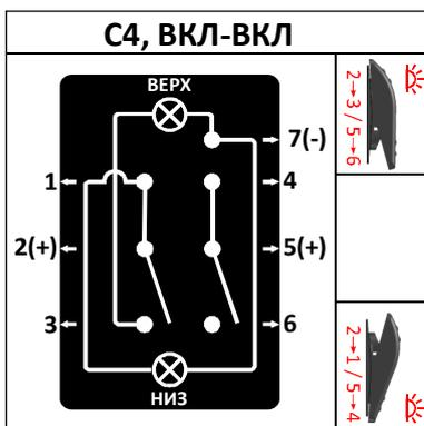
**Верхнее положение:** включен, фиксированное, горит верхний светодиод.
