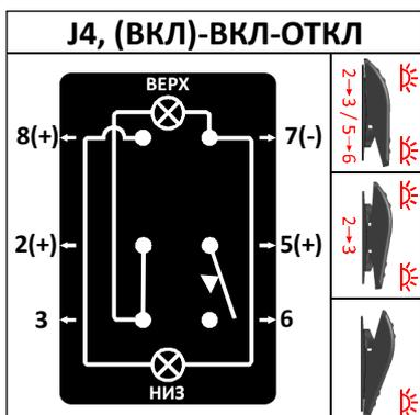
**Верхнее положение:** включен, НЕ фиксированное, горит нижний и верхний светодиод.
