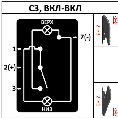
**Верхнее положение:** включен, фиксированное, горит верхний светодиод.
