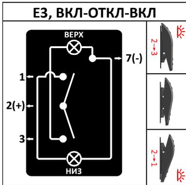
**Верхнее положение:** включен, фиксированное, горит верхний светодиод.
