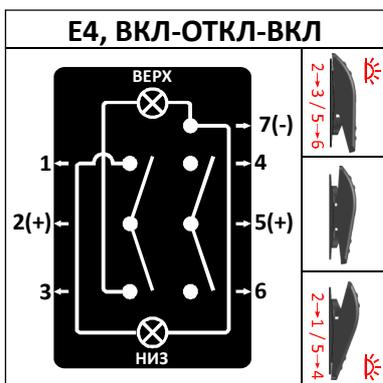
**Верхнее положение:** включен, фиксированное, горит верхний светодиод.
