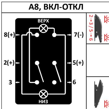
**Верхнее положение:** включен, фиксированное, горит нижний и верхний светодиод.
